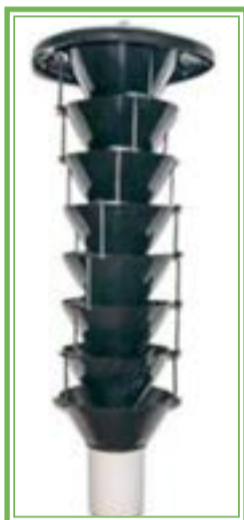
Trampa Lindgren utilizada para constatar la ausencia del escarabajo barrenador polífago y el escarabajo marchitez del laurel rojo. Se utilizan atrayentes alimenticios colocándose en el cuarto embudo.
